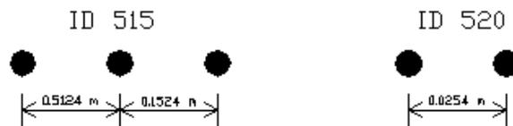
**Fig.160: Distanze tra i conduttori per linee in cavo**
