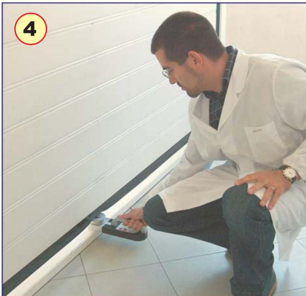
**Le Misure** - La prime tre misure vengono effettuate a 5 cm di distanza dal pavimento in zona centrale, poi tre misure a destra ed infine altrettante a sinistra (vedi fig. 4)
